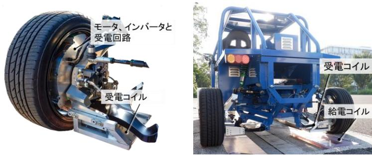
図2 探索研究で開発したワイヤレスインホイールモーターと試験車両
