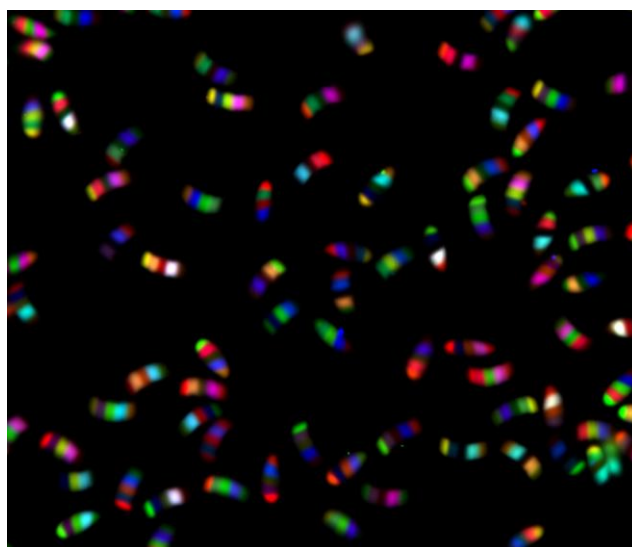
図 1：光学バーコードビーズの顕微鏡画像
