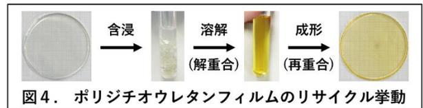
時間で完全に溶解し、続いて溶媒キャストによってフィルムを再成形することができました（図4）。再成形されたフィルムの修復率はリサイクル操作の前後で同程度の値を示したことから、修復性能が劣化したフィルムをリサイクルすることによって性能を回復できることがわかりました。
