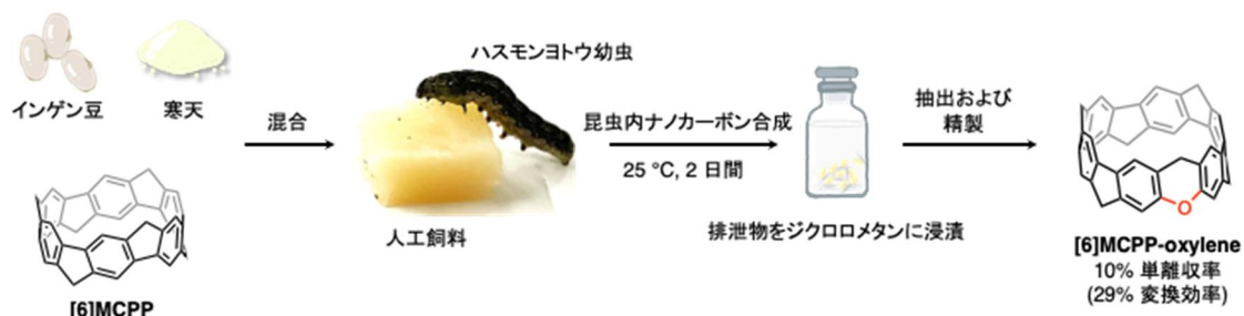
図1 ハスモンヨトウ幼虫による昆虫内ナノカーボン合成
