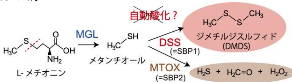
図2：本研究で明らかにした「臭い花」のにおい成分「ジメチルジスルフィド(DMDS)」の生合成経路。これまで、DMDSはメタンチオールが酵素反応を経ずに酸化して生じると考えられていたが、この反応を担う酵素ジスルフィドシンターゼ(DSS)を発見した。 MGL: メチオニンガンマリアーゼ。MTOX: メタンチオールオキシダーゼ。
