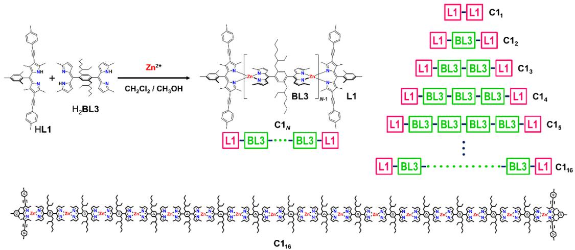
図1. ナノチェーン  $C1_N$  の合成。図左上の原料分子から、亜鉛イオンが1~16個連なったナノチェーンが合成・単離された。図下は、亜鉛イオンが16個連なった、単離された中で最長のナノチェーンの構造を示す。
