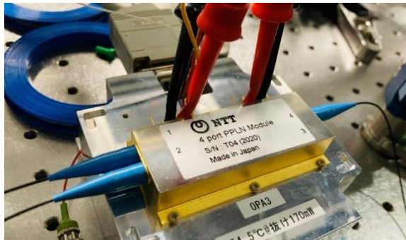
図1：今回の実験で用いた光パラメトリック増幅器（左）とモジュール内部の概念図（右）
