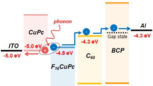
(図1) 新型有機熱電デバイスの動作機構(エネルギー準位と電荷の移動の様子)。
