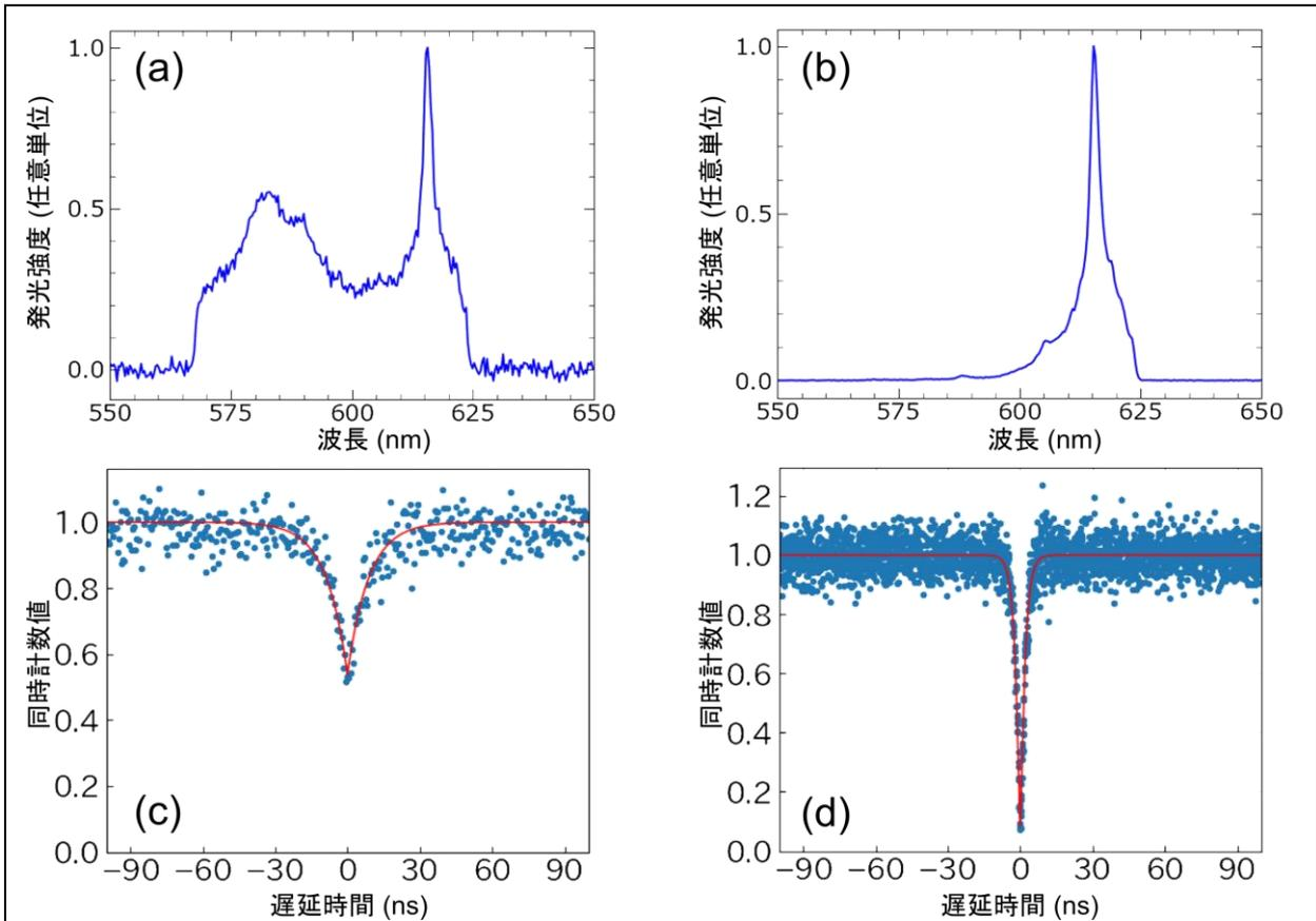
図 4 (a)および(b) それぞれ、波長 532 nm および波長 637 nm のレーザーで励起した場合の発光スペクトル。637 nm で励起した場合、532 nm で励起した際に観測された 580 nm 付近の幅広い発光が大きく抑制されました。(c) および (d) 光子の単一性を評価するための 2 次の強度相関測定の結果。波長 532 nm で励起した場合、遅延時間が 0 ns 付近の同時計数値は  $0.53 \pm 0.02$  となり複数の色中心から光子が発生していることがわかりました。一方、波長 637 nm で励起した場合、同時計数値は  $0.08 \pm 0.05$  まで減少し、複数の色中心が含まれる場合でも単一光子源として動作していることがわかりました。
