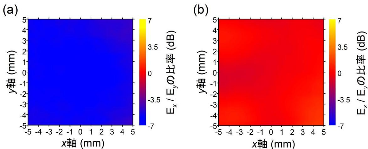
図 4 (a) 共鳴トンネルダイオード単体と(b) 平面レンズと円偏波変換板の
