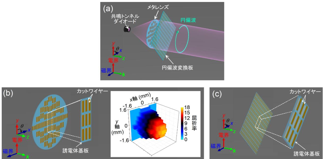
図 1 (a) 鋭い指向性の円偏波の発生に用いた光学素子 (b) 平面レンズ。メタアトムのパラメータ(微細な構造の大きさや並べる間隔)を変化させると、屈折率が変化する。レンズ内で屈折率の傾斜をつけることで、電磁波が広がらずにある特定の方向に進むようになる。 (c) 円偏波変換板。電界が一方向のみに振動する平面波を、 $x$  軸方向と  $y$  軸方向の両方に電界が振動する円偏波へと変換する。
