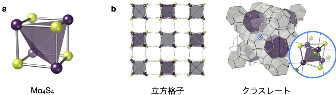
図1 (a) 立方体型の超原子Mo<sub>4</sub>S<sub>4</sub>クラスターと (b) 先行研究で報告されていた三次元集積体のモデル図。
