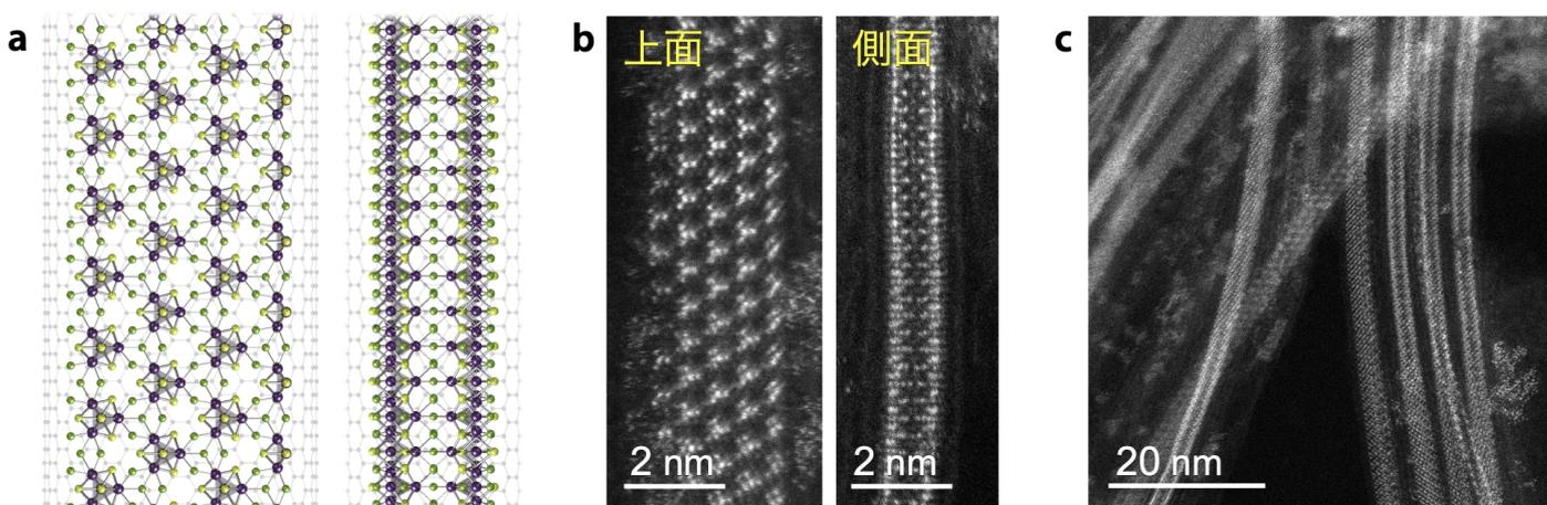
図3 (a) カーボンナノチューブの内部空間に成長したMo<sub>8</sub>S<sub>8</sub>Cl<sub>11</sub>ナノリボンのモデル図および (b, c) 透過電子顕微鏡写真。モデル図と同様の構造が安定して存在している。
