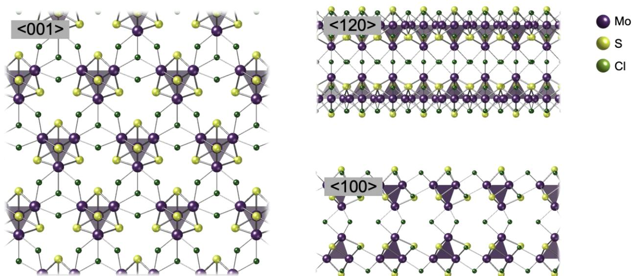
図2 超原子層「Mo<sub>8</sub>S<sub>8</sub>Cl<sub>11</sub>」のモデル図。<001>、<120>、<100>はそれぞれ、異なる方向からMo<sub>8</sub>S<sub>8</sub>Cl<sub>11</sub>を見た際の配列を示す。
