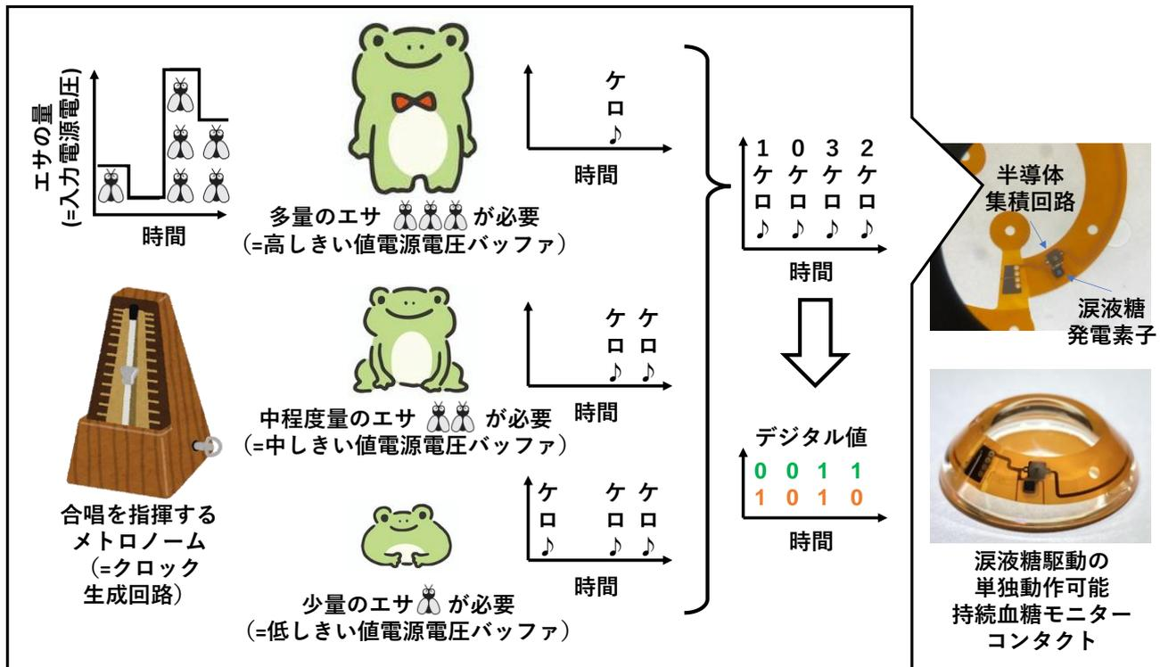
図1 本研究開発のイメージ図：提案回路の動作を、カエルの合唱と例えて表現している。歌声を発するのに必要なエサの量が異なるカエル達を複数設け (動作しきい値電源電圧の異なるバッファを複数設け)、環境中に存在するエサの量 (環境中で得られる電源電圧) に応じて、指揮を受けた時に歌声を発するカエルの数 (クロックを与えられた時に動作する回路の数) が変化することを活用してデジタル変換を行う。この技術を、涙液糖濃度に応じて出力が変化する涙液糖発電素子と組み合わせることで、涙液糖と相関のある血糖推定に活用する。
