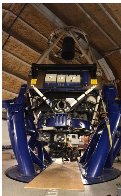
図2：アメリカ・マウイ島ハレアカラ観測所の2 m Faulkes Telescope Northに搭載された MuSCAT3 クレジット：MuSCAT チーム
