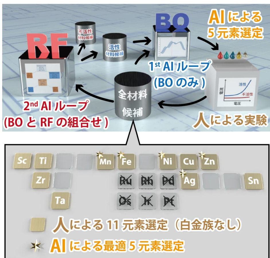
図 2 本研究における Human-Machine Collaboration の概要。BO は回帰モデルを利用した最適化手法であるベイズ最適化を表し、RF は分類モデルとして利用したランダムフォレストを示します。
