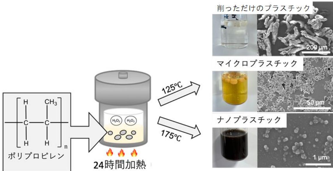
図1. ポリプロピレンと過酸化水素 ( \text{H}_2\text{O}_2 ) を水中で高温・高圧処理することにより、温度に応じてマイクロプラスチック、ナノプラスチックが作製できる。右写真は走査型電子顕微鏡による観察結果。
