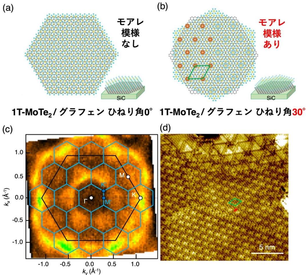
図 4. (a,b) グラフェンと原子層 MoTe<sub>2</sub> を重ねることによって現れるモアレ模様。ひねり角  $\theta = 0^\circ$  の場合(a)はモアレ模様が現れませんが、 $\theta = 30^\circ$  の場合 (b) は実験 (d) で観測された周期性 (緑線) と同じモアレ模様が現れます。(c) 原子層 MoTe<sub>2</sub> における光電子強度の運動量分布 (フェルミ面)。黒の六角形は 1T-MoTe<sub>2</sub> のブリルアンゾーン (注 11) で、水色の六角形がモアレ模様によって変化した 1T-MoTe<sub>2</sub> のブリルアンゾーン。(d) 原子層 MoTe<sub>2</sub> の走査トンネル顕微鏡像。菱形状の赤枠は原子層 MoTe<sub>2</sub> の単位胞、緑枠はモアレ模様による超周期構造の単位胞に対応します。
