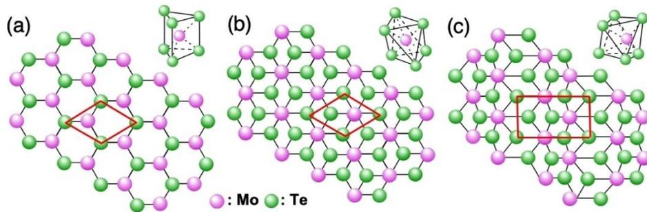
図 2. 原子層 MoTe<sub>2</sub> の結晶構造。(a) が三角プリズム型構造、(b) が正八面体型構造 (1T)、(c) が 1T 構造を歪ませた 1T' 構造に対応します。赤線が単位格子に対応します。
