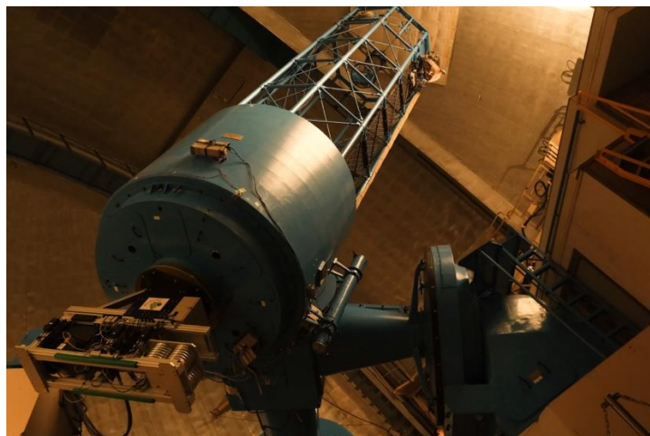
図2：国立天文台ハワイ観測所岡山分室 188 cm 望遠鏡に取り付けられた多色同時撮像カメラ MuSCAT
