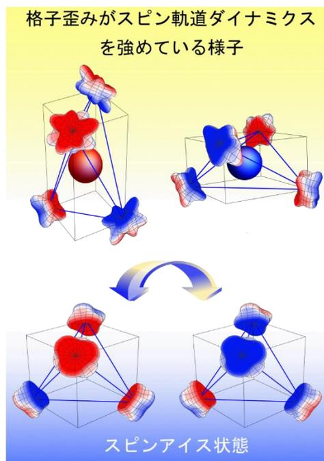
図 3 : スピンと軌道の量子的な絡み合いが結晶格子の歪みを通じて実現する機構の模式図。 下の二つの正四面体は異なる 2-in,2-out 相関を持つスピナイス状態。 上の二つの四面体は、二種類の格子歪みにより変形しています。  $\text{Pr}_2\text{Zr}_2\text{O}_7$  は、この変形状態を通して異なるスピナイス状態の間を量子力学的に行き来する (=量子揺らぎ) ことができ、量子スピナイス状態を安定化させていると考えられます。
