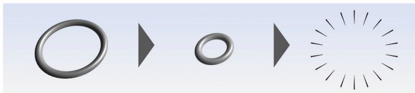
図 3：線欠陥の再結合と、ループ収縮・消滅の模式図
