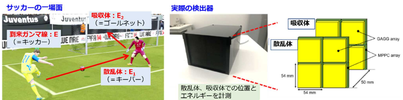
図 7 左) サッカーの場面に例えた、コンプトンカメラの撮像原理 右) 実際に雷雲のイメージングに用いたコンプトンカメラの構成。「散乱体」「吸収体」での反応位置とエネルギーを計測する。
