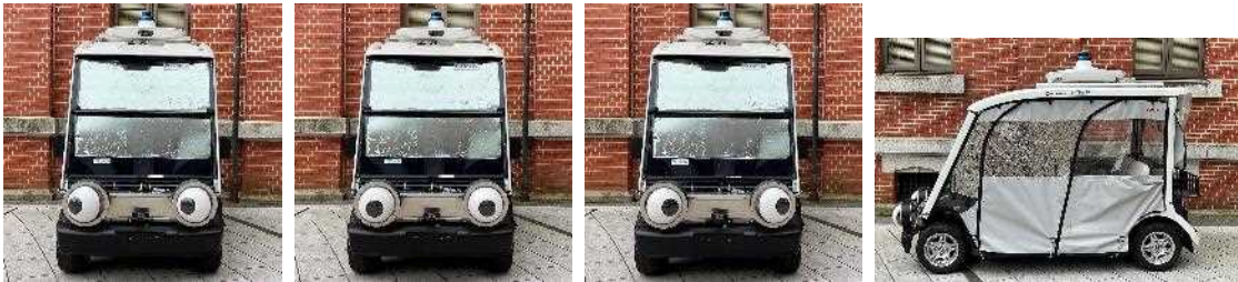
図 1: 視線提示できる目を付与した自動運転車の実験車両。
