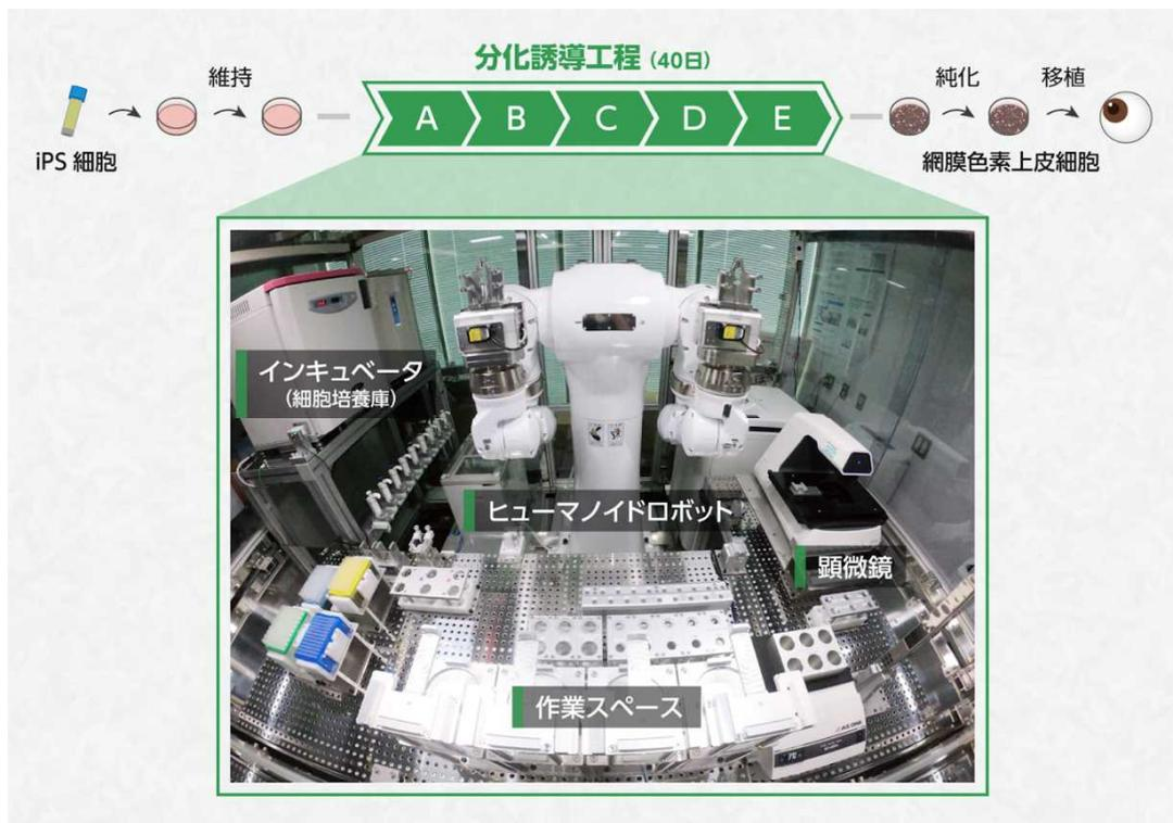
図1 iPS細胞からRPE細胞への分化誘導工程を実装したLabDroid「まほろ」
