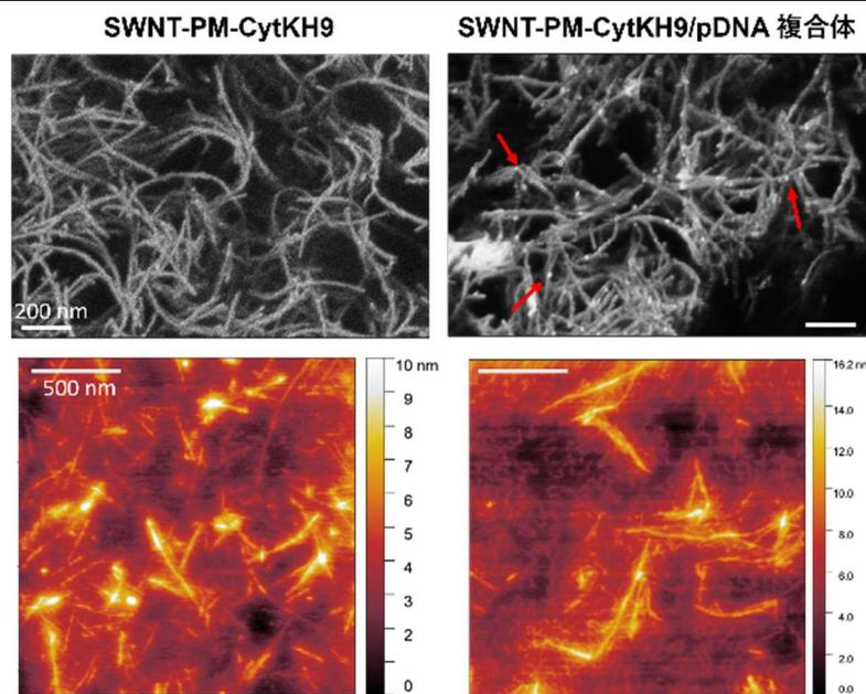
図 1 機能性ペプチドを結合したカーボンナノチューブと DNA の複合化
