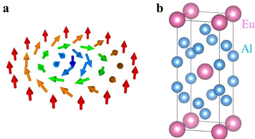
図1：(a) 一つの磁気スキルミオンの模式図。各矢印はユウロピウム (Eu) 原子それぞれの磁気モーメントの向きを示している。(b)  $\text{EuAl}_4$  の結晶構造。
