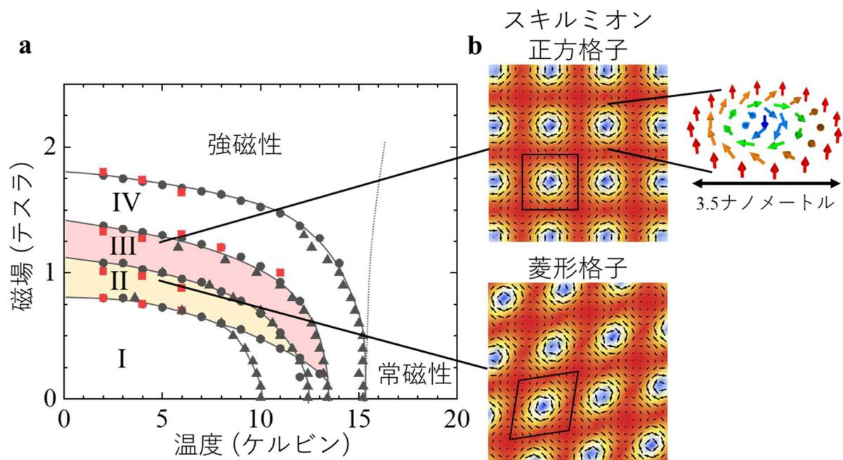
図2 : (a)EuAl<sub>4</sub>の磁気相図。(b)観測した磁気スキルミオンの正方格子 (III) および菱形格子 (II) の模式図。背景色は、電子が持つ磁気モーメントの紙面垂直成分の向きを表しており、赤い部分で手前側、青い部分で向こう側を向いている。
