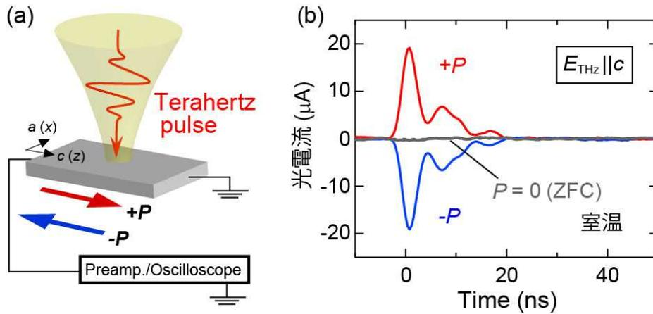
図2. (a)実験の配置図。テラヘルツ光はサンプルの表面垂直方向から照射し、c 軸（電気分極）と平行な光電流を測定した。(b)室温における光電流の測定値。電気分極状態をプラス、マイナス、ゼロの場合について測定している。電気分極の値に比例した光電流生成が観測されている。テラヘルツ光がパルス光源のため、光電流もパルス状に流れている。
