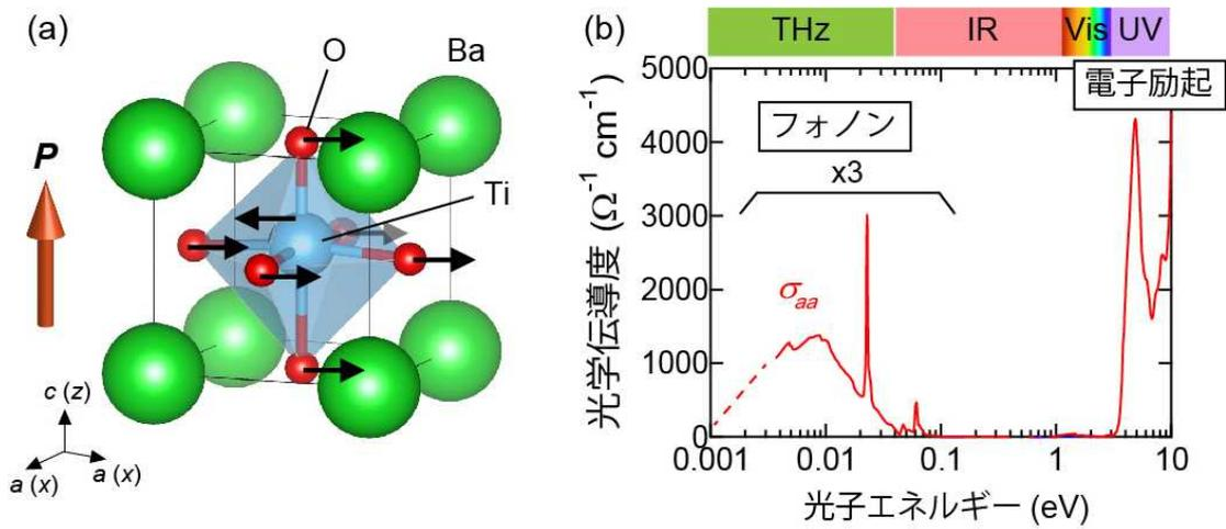
図1. (a)強誘電体 BaTiO<sub>3</sub>の結晶構造。c 軸方向に強誘電分極 ( $P$ ) が生じる。黒矢印はフォノン励起における原子変位パターンの1例を示した。(b)光学伝導度スペクトル。フォノン励起はテラヘルツ帯に、電子励起は紫外領域 (UV) に存在している。
