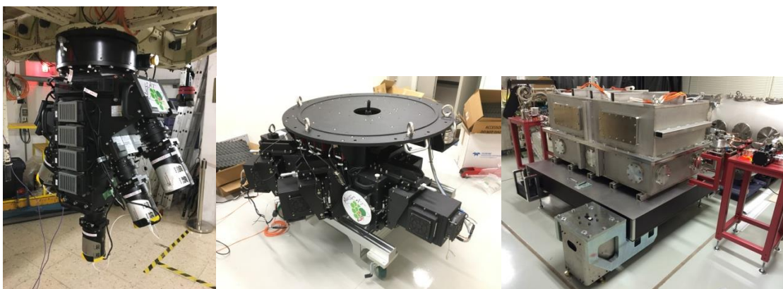
図 2：TOI-2285b の発見に貢献した観測装置。左からスペイン・テネリフェ島の 1.52m 望遠鏡に搭載された MuSCAT2、アメリカ合衆国・マウイ島の 2m 望遠鏡に搭載された MuSCAT3、アメリカ合衆国・ハワイ島のすばる望遠鏡に搭載された IRD。（クレジット：MuSCAT2,3 は東京大学、IRD はアストロバイオロジーセンター）
