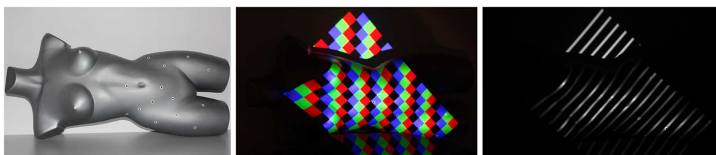
図 4 本プロジェクタによる画像投影を行ったトルソー(左)と、同トルソーに RGB 画像と IR 画像を同時に投影しながら、それぞれ RGB 画像のみを撮像可能なカメラで撮影した写真(中央)、および IR 画像のみを撮像可能なカメラで撮影した写真(右)。
