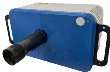
図 3 今回新たに開発した高速 RGB+IR プロジェクタ。46 cm × 28 cm のコンパクトなボディに、RGB 画像と IR 画像の同時投影に必要なデバイスが搭載されている。
