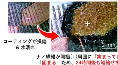
図2 既存技術とは全く異なるメカニズムで水濡れ故障を防ぐため、コーティングが損傷した状態からでも効果を発揮します。
