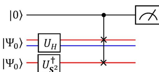
$U_{S^2}$ が作用するのは赤色の横線で示した開殻分子軌道の占有数を保持した量子ビット群だけなので、 $U_{S^2}$ ゲートの位置を変えることで、青色で示した量子ビット群を削除できる
