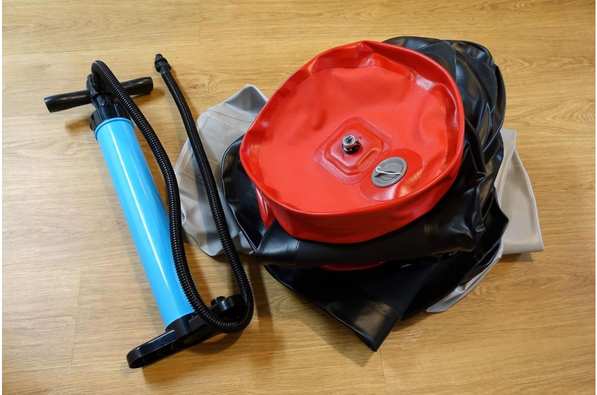
バイク型 poimo を折りたたんだ様子と手動ポンプ。 丸めてボストンバッグに収納できる。
