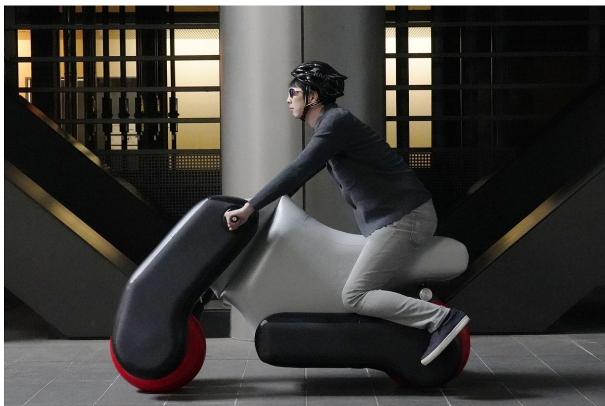
電動バイク型の poimo。上のポーズから下のようなバイクを自動設計する。
