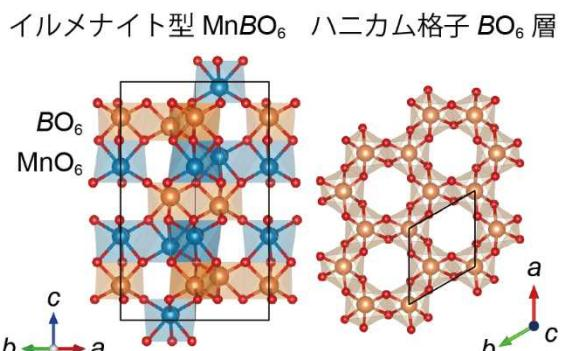
図2. イルメナイト型  $MnBO_6$  の結晶構造。
