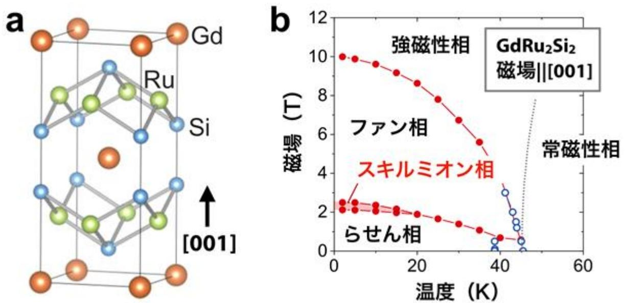
図2 : (a)GdRu<sub>2</sub>Si<sub>2</sub>の結晶構造。(b)GdRu<sub>2</sub>Si<sub>2</sub>の積層方向に磁場を加えた際の温度磁場相図。
