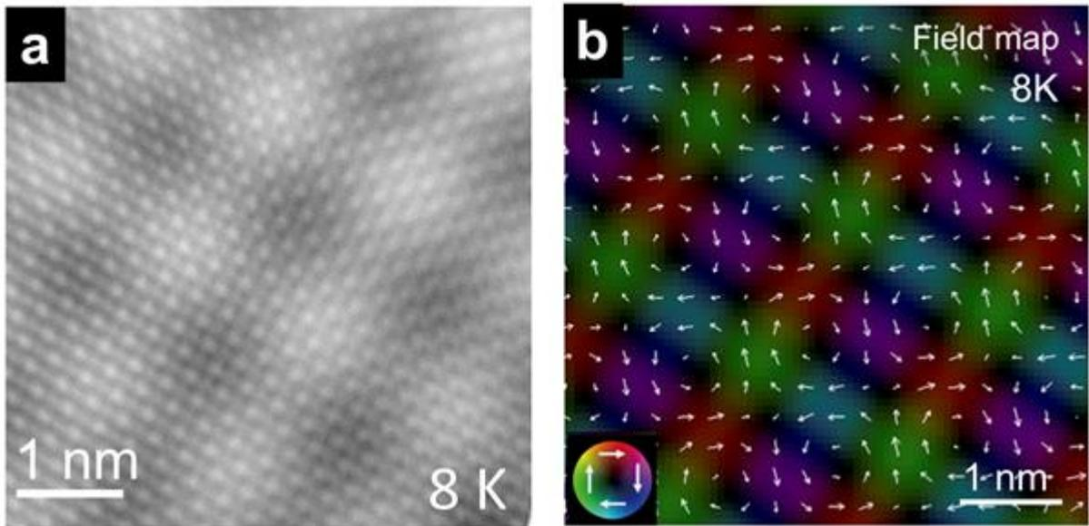
図 3 : (a) $\text{GdRu}_2\text{Si}_2$  のスキルミオン正方格子相におけるローレンツ電子顕微鏡像（ノイズを除去するために逆格子空間でフィルタリングを施したもの）。周期的に並んだ小さな原子像の上に、より長周期のスキルミオン正方格子の磁気コントラストが重畳している様子が読み取れる。観察しているのは(001)面で、磁場は面直方向に加えている。(b)電子顕微鏡像を解析することで得られた面内磁化の空間分布。図 1(b)と同じように、渦巻き状のスピンの構造が正方格子を組んでいる様子が読み取れる。
