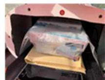
ドローン下部の格納室に医薬品を収納し運搬。
