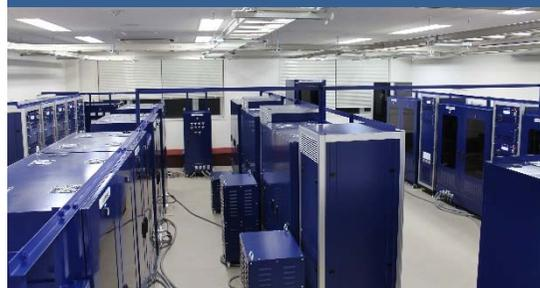
配電システムシミュレータ
