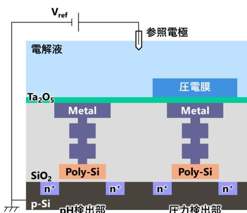
■ pH/圧力センサ構造
