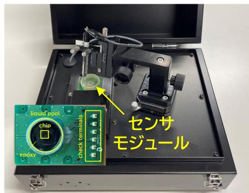
■ センサモジュールを組み込む計測装置
