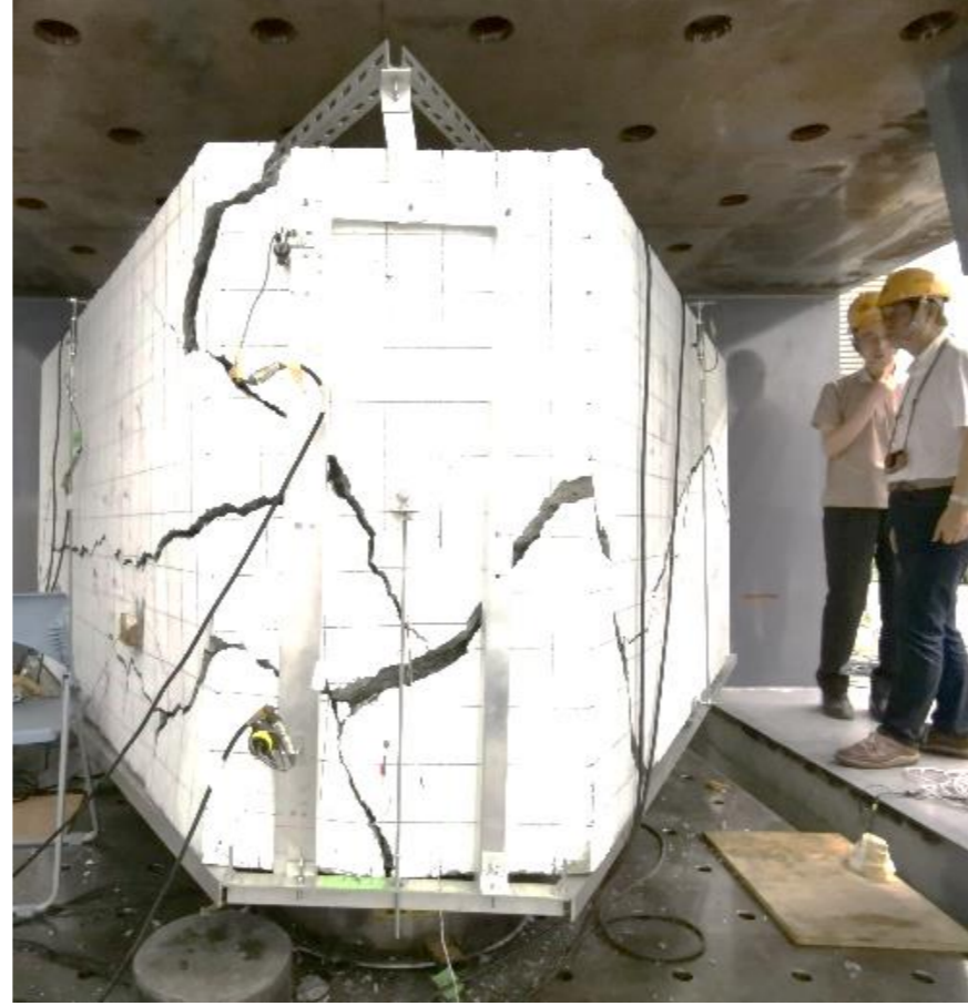
大試験体の破壊性状
