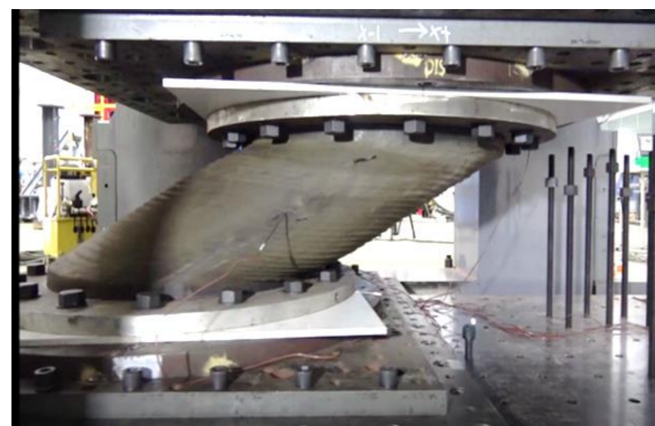
免震支承の変形(大試験体)
