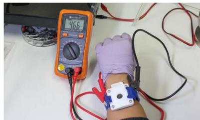
腕に巻くだけで計測可能な二酸化炭素皮膚センサー。写真は二酸化炭素を計測中のもの。
