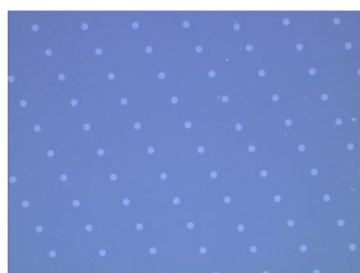
メディア上に記録された透明溶媒液滴の着弾跡（左），その二値化処理画像（中） 二値化画像から算出した着弾位置（右）
