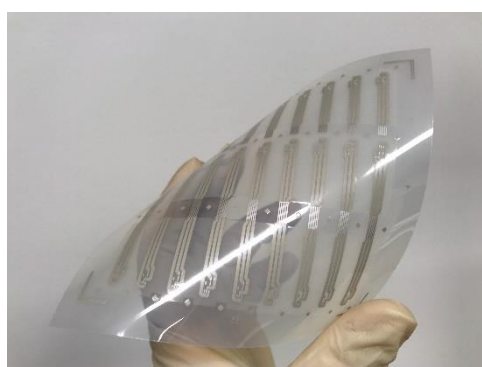
写真 5 スクリーン印刷で作製したフレキシブル温度センサプローブ（個別カット前）
