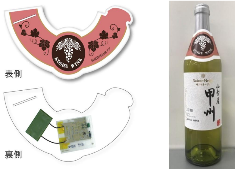
図 4 FHE 型温度センサラベルイメージ（ワインボトル用）
