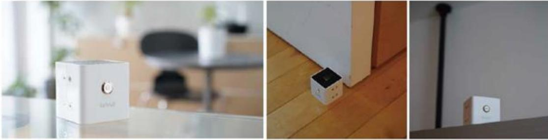
6センチメートル角のCubicな測定装置。電源 On/Off 操作のみで室内の多様な環境データを取得します
