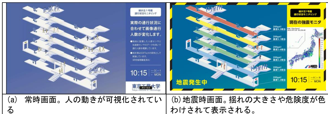
図 5.5.4 緑が丘 1 号館モニタリングシステム画面
