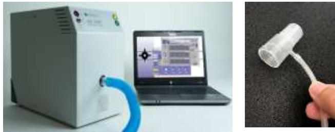
図 6. 人工肺モデル (左) と専用の鼻カニューラ接続 (右)
