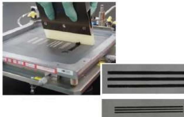
図 4. スクリーン印刷による SWCNT ベルトの作製
