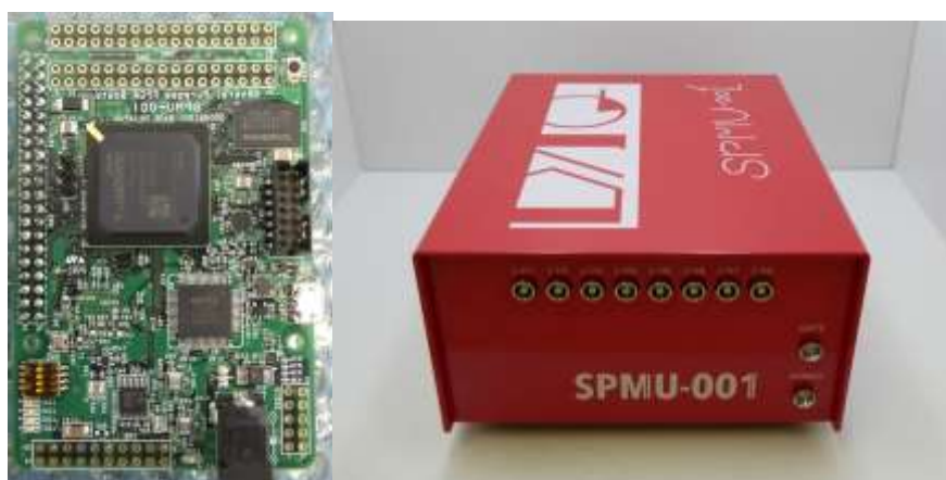
図 9 シマフジ電機と共同開発した SPMU-001 ボードと、それを収納したデータ収集装置
