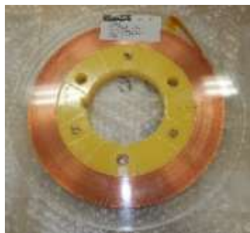
図 5-1-2-5 性能試験用高温超電導コイル製作のために入手した REBCO 線材
