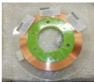
図 5-1-2-5 性能試験用高温超電導コイル製作のために入手した REBCO 線材
