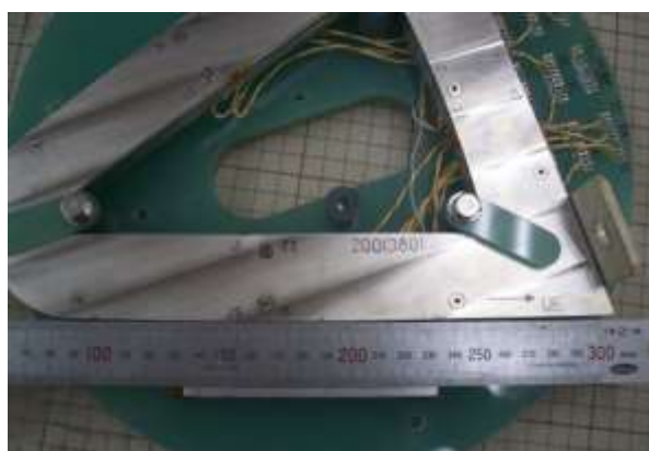
図 5-1-2-22 特性評価試験後の供試コイル (長辺部：外側への若干の膨らみあり)
