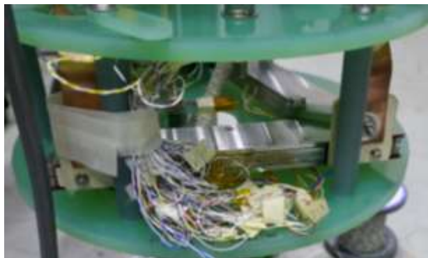
図 5-1-2-17 治具に取り付けられた YOROI 補強 REBCO-DP コイル
