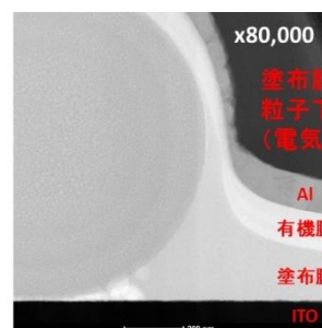
異物への被覆状態（断面 TEM 画像）
