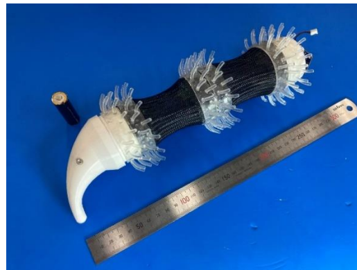
\phi 75\text{mm} の配管探索ロボの節を直接に3個連結して先端に角を付けたもの
