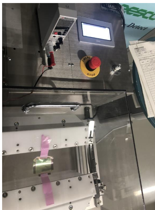
10 万回屈曲試験後
