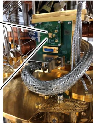
低損失伝送基板設計 & 実装完
