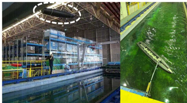
図2 VMドローン試作ゼロ号機による水槽試験の様子です。クレーンで天井付近まで吊上げた試作機(白破線)を水槽へ落下させる強度試験(左図)です。試作機マスト位置に六軸力センサーを付け、計測台車を高速で水槽上を走らす曳航試験(右図)です。
