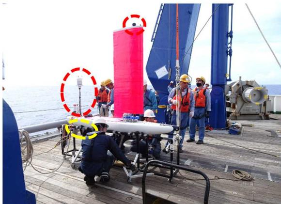
図1 「みらい」熱帯北西太平洋航海における、VMドローン試作2号機に艦装された改修済み大気センサー(赤破線丸)と海洋センサー(黄破線丸)。試作機の外洋展開前には、観測センサー類やデータ通信機器等の入念な点検を行います。
