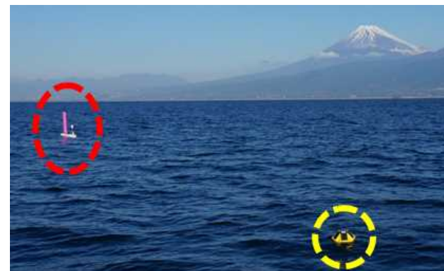
図3 VMドローン試作1号機(赤破線)に艦装した海洋観測センサー(MOF:汎用小型観測フロート)検証のため、沿岸海域試験では Spotter 漂流ブイ(黄破線)との同時観測を実施。
