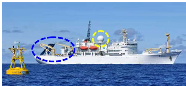
図1 VMドローン試作機の外洋試験に用いる海洋地球研究船「みらい」。VMドローンの海上展開や揚収作業には船尾甲板上のAフレームクレーン(青破線)等を用い、船体中央のCバンド二重偏波レーダー(黄破線)ほか大気海洋観測装置によりVMドローン試作機の取得データ検証を実施予定です。
