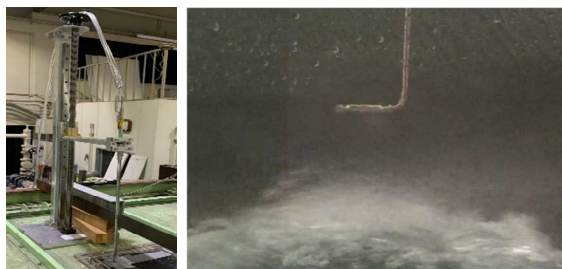
図2 水槽の上部に設置されたピトー管(左)と水槽内での風速測定の様子
