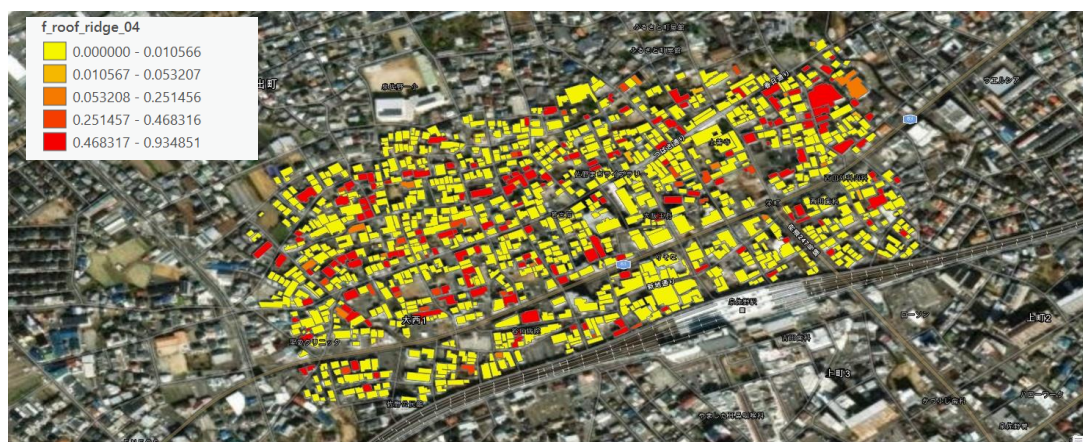
図1. 各建築物の部位(図は屋根棟部の屋根ふき材)の被害(再調達価格比)の計算結果
