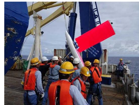
図3「みらい」熱帯北西太平洋航海(MR23-05 Leg.1)においてVMドローン試作2号機を後部甲板から海上へ展開する作業の様子。この後、写真両側に見える青いAフレームクレーン(図1)で吊り上げ、クレーンアームを大きく海上へ振り出して安全にゆっくり着水させます。
