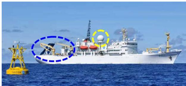
図1 VMドローン試作機の外洋試験に用いた海洋地球研究船「みらい」。VMドローンの海上展開や揚収作業には船尾甲板上のAフレームクレーン(青破線)等を用い、船体中央のCバンド二重偏波レーダー(黄破線)ほか大気海洋観測装置によりVMドローン試作機の取得データ検証等を実施しました。
