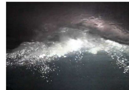
図2：飛散する液滴と水中に巻き込まれる気泡の様子
