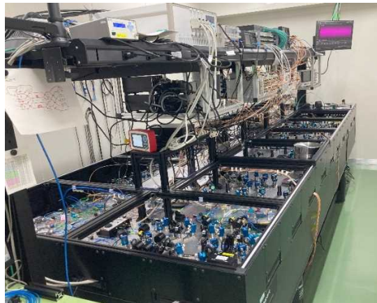
写真：理研に設置した光量子コンピュータ実機
